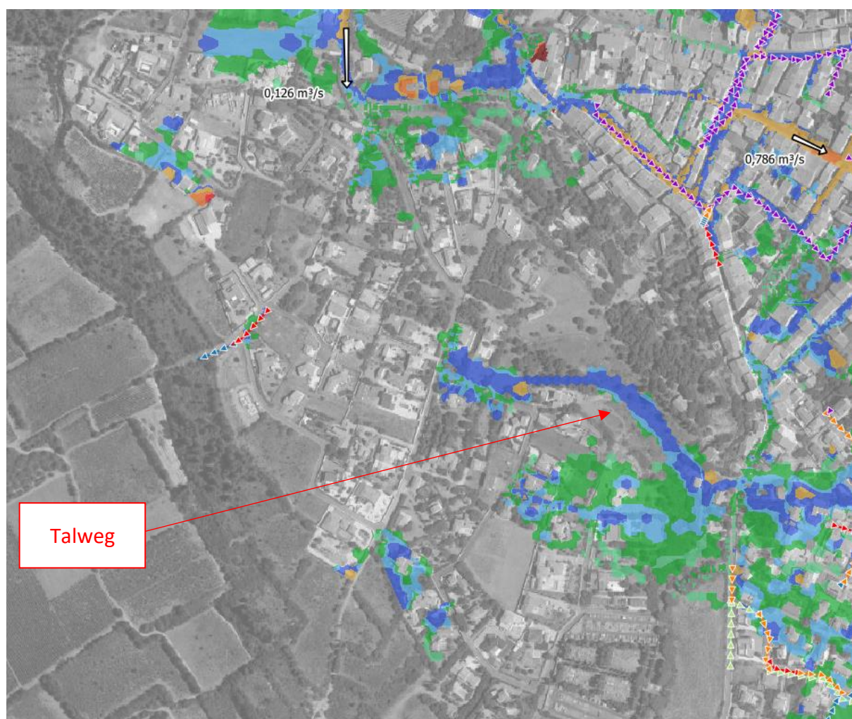
Figure 18 : Simulation de l'occurrence centennale pour le bassin versant Ouest
