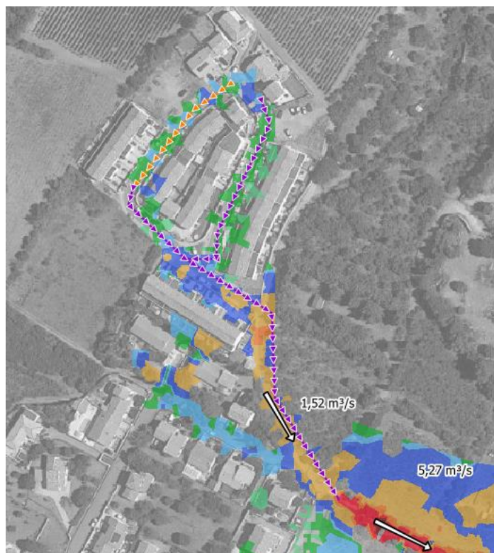
Figure 9 : Simulation de l'occurrence centennale au droit du chemin de Candestre
